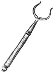
**Ухва́т** — незамкнутый обруч на длинной палке, служит для задвигания чугунов в печь и доставания их оттуда. Диаметр обруча ухвата зависит от величины чугуна.
